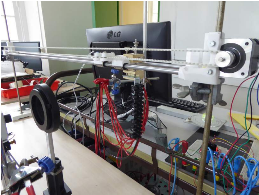
FIGURE 5 – Photo du montage sur laquelle on peut voir la barrette de micros.
